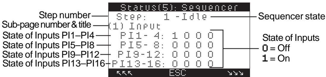
**Figure 5-9.** *Sequencer Inputs*
